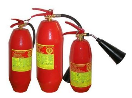
Огнетушители углекислотные предназначены для тушения загораний различных горючих веществ, горение которых не может происходить без доступа воздуха (в том числе, электроустановок, работающих под напряжением до 1000 В). Основное их преимущество перед огнетушителями других видов — минимальное нанесение вреда защищаемому объекту.
