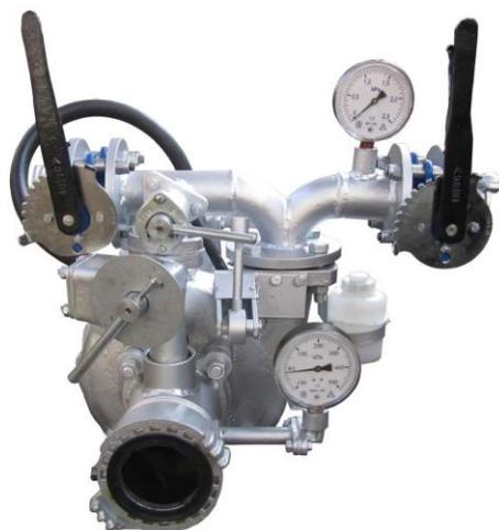
Насос НЦС-20/160 предназначен для подачи воды и водных растворов пенообразователя с температурой до 303°K (30°С), плотностью до 1100кг/м<sup>3</sup> и массовой концентрацией взвешенных твёрдых частиц грунта до 0,5%, при их максимальном размере 3мм.
