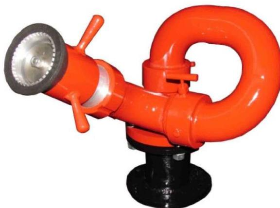
Стволы пожарные лафетные, стационарные, водопенные, универсальные. Стволы с регулируемым насадком с расходом воды 20 л/с, 15л/с, 25л/с с ручным управлением. Предназначенный для формирования распыленной струи огнетушащего вещества с изменяющимся углом распыливания от сплошной струи до защитного экрана 900. Ствол применяется для тушения пожаров, охлаждения строительных и технологических конструкций, осаждения облаков ядовитых или радиоактивных газов, паров и пыли.
